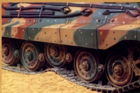
Independent torsion bar suspension Suspensión independiente mediante barras de torsión (36204)
