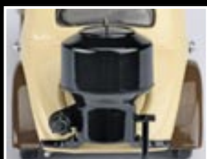
Mercedes-Benz 170V mit Holzvergaser/ sedan with woodgas generator/limousine gazogène
