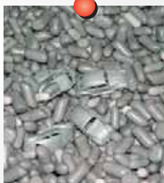
Trowalisieren - mechanisches Entfernen feiner Spritzrate ...
