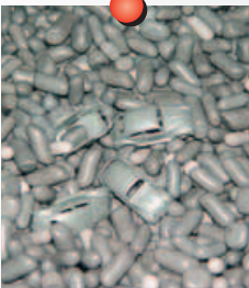
Trowalisieren - mechanisches Entfernen feiner Spritzgrate ...
