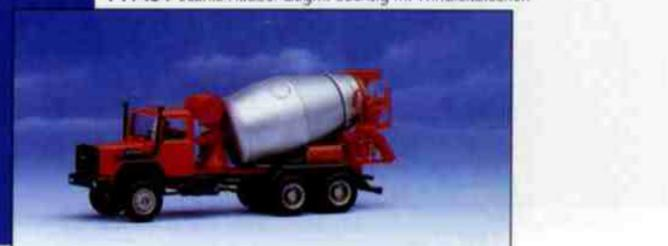
141475 Iveco Hauber 3achsrig mit Betonmischtrommel
